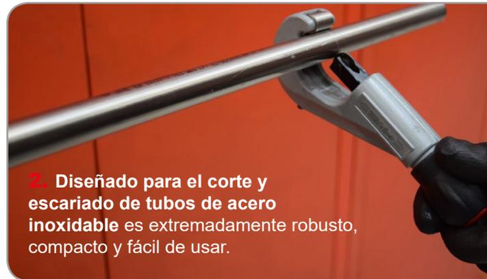
**2. Diseñado para el corte y esariado de tubos de acero inoxidable** es extremadamente robusto, compacto y fácil de usar.
