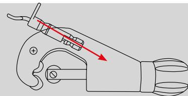
**6. Rodillos sin ranura fabricados en acero inoxidable** para evitar contaminaciones.
