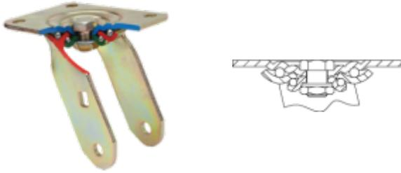
Fabricada con acero hasta 5m/m de espesor. Acabado cincado bicromatizado. Cabezal giratorio con una pista endurecida de doble hilera de bolas, para una mayor longevidad de la rueda. Fabricadas según normas europeas EN 12532.
