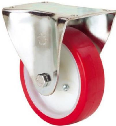
Ruedas con núcleo de nylon blanco y banda de poliuretano rojo inyectado de dureza 90-95° shoreA. Especialmente indicada para soportar cargas hasta 450 Kg.
