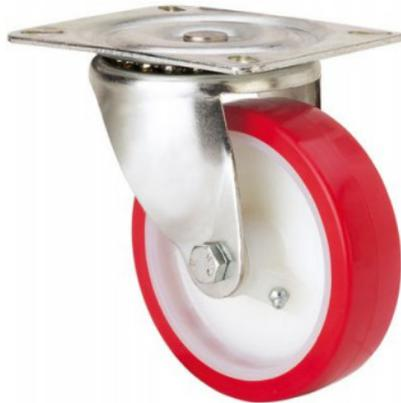
Ruedas con núcleo de nylon blanco y banda de poliuretano rojo inyectado de dureza 90-95° shoreA. Especialmente indicada para soportar cargas hasta 450 Kg.
