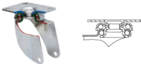
Fabricada con chapa de acero embutida hasta 2 mm de espesor. Soporte con rodamiento a bolas. Acabado cincado. Ruedas de goma de 50 y 60 de diámetro con protectores incluidos de serie. Fabricadas según normas europeas EN 12528.
