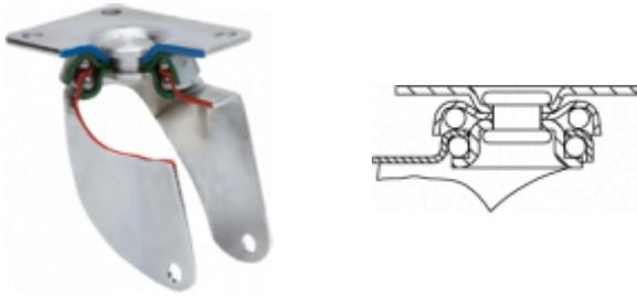
Fabricada con chapa de acero embutida hasta 2 mm de espesor. Soporte con rodamiento a bolas. Acabado cincado. Ruedas de goma de 50 y 60 de diámetro con protectores incluidos de serie. Fabricadas según normas europeas EN 12528.
