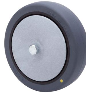
Núcleo de polipropileno y banda de poliuretano gris conductivo( 95° shore A)
