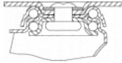
Fabricada con chapa de acero hasta 2 m/m de espesor. Soporte con doble rodamiento a bolas de gran tamaño. Acabado cincado brillante. Fabricadas según normas europeas EN 12530.
