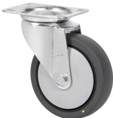
Ruedas conductivas con núcleo de polipropileno y banda de poliuretano gris inyectado. Especialmente indicada para soportar cargas hasta 200 Kg.
