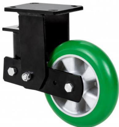
Ruedas con núcleo de aluminio y banda de poliuretano verde fundido en forma balona con dureza 80° Shore A. Especialmente indicada para soportar cargas hasta 650 Kg. Con soporte de suspensión elástica mediante incorporación de muelle muy resistente para absorber golpes, choques y desniveles. Recorrido de suspensión hasta 25mm., ideal en suelos irregulares donde su amortiguación actúa.
