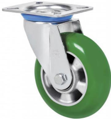
Ruedas con núcleo de aluminio y banda de forma balona de poliuretano verde de dureza 80° shoreA. Especialmente indicada para soportar cargas hasta 650 Kg.
