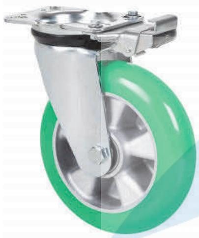
Ruedas con núcleo de aluminio y banda de poliuretano verde de dureza 80° shoreA. Especialmente indicada para soportar cargas hasta 650 Kg.
