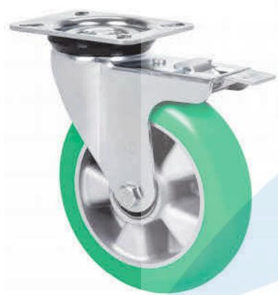
Ruedas con núcleo de aluminio y banda de poliuretano verde de dureza 80° shoreA. Especialmente indicada para soportar cargas hasta 650 Kg.
