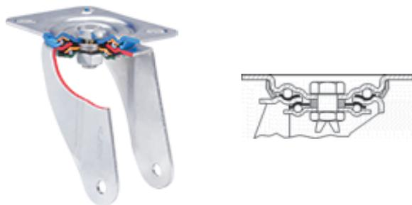
Fabricada con chapa de acero embutido hasta 4 m/m de espesor. Doble rodamiento a bolas reforzado con pistas de rodadura endurecidas. Protector anti-polvo en el cojinete. Fabricadas según normas europeas EN 12532/12533.
