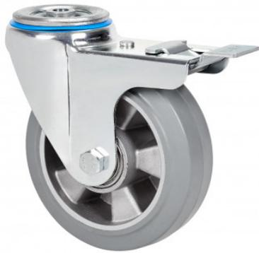
Ruedas de núcleo de aluminio con banda de goma elástica gris con una dureza 70° shore A. Especialmente indicada para soportar cargas hasta 450 Kg.
