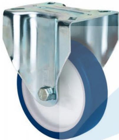
Ruedas con núcleo de poliamix blanco y banda de poliuretano azul inyectado blando de dureza 80° shore A. Especialmente indicada para soportar cargas hasta 250 Kg.
