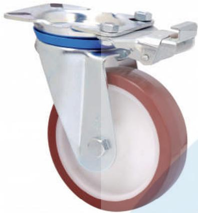
Ruedas con núcleo de poliamix blanco y banda de poliuretano marrón inyectado de dureza 95° shore A. Especialmente indicada para soportar cargas hasta 300 Kg.
