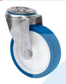
Ruedas de poliuretano inyectado blando azul con todos sus componentes de acero inoxidable (AISI 304). Especialmente indicada para soportar cargas hasta 250 Kg.
