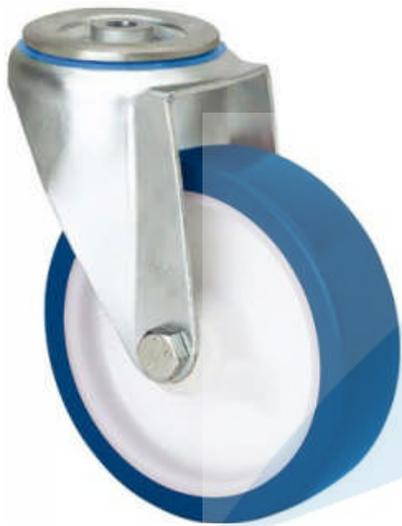
Ruedas con núcleo de poliamix blanco y banda de poliuretano azul inyectado blando de dureza 80° shore A. Especialmente indicada para soportar cargas hasta 250 Kg.
