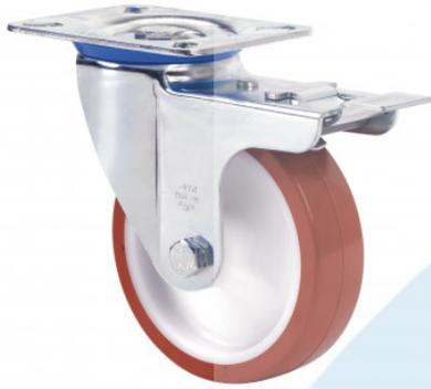
Ruedas con núcleo de poliamix blanco y banda de poliuretano marrón inyectado de dureza 95° shore A. Especialmente indicada para soportar cargas hasta 300 Kg.
