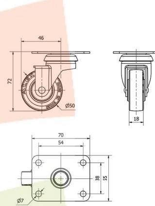
Para visualizar la imagen con mayor resolución y mas detalles técnicos, puedes acceder a la sección del CAD.
