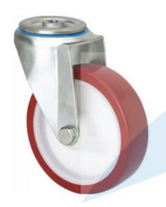
Ruedas con núcleo de poliamix blanco y banda de poliuretano marrón inyectado de dureza 95° shore A. Especialmente indicada para soportar cargas hasta 300 Kg.
