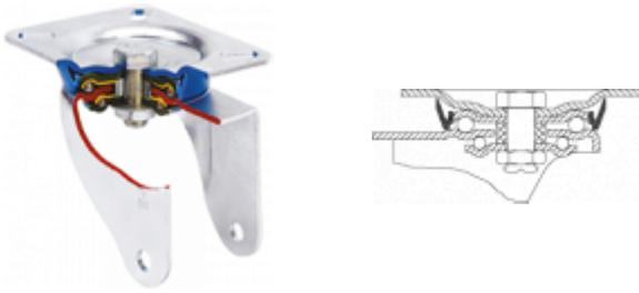
Fabricada con chapa de acero embutido hasta 5m/m de espesor. Acabado cincado brillante de alta resistencia al óxido. Doble rodamiento a bolas reforzado con platillos intermedios y pistas de rodadura endurecidas. Protector anti-polvo en el cojinete del soporte. Fabricadas según normas europeas en 12532.
