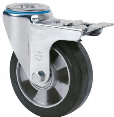
Ruedas de núcleo de aluminio con banda de goma negra elástica con una dureza 70° shore A. Especialmente indicada para soportar cargas hasta 400 Kg.
