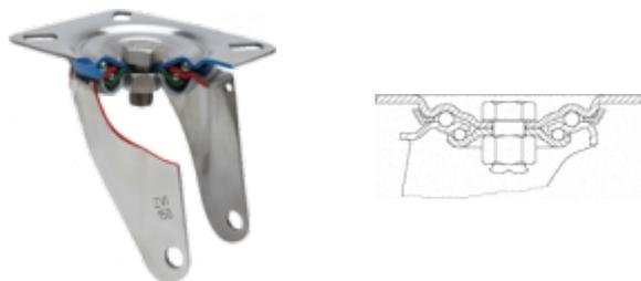
Fabricada con chapa de acero inoxidable (AISI 304). Hasta 3 m/m de espesor. Todos sus componentes de acero inoxidable. Resistente a la corrosión, grasas, aceites y gasolina. Fabricadas según normas europeas EN 12530/12532.
