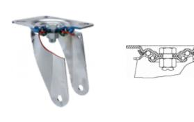
Chapa de acero hasta 4mm de espesor. Acabado cincado brillante. Soporte embutido con doble hilera de bolas. Modelo de uso universal para cargas medias. Fabricadas según normas europeas EN 12530/12532.
