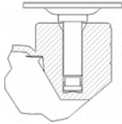
Soporte con placa y espiga roscada, con y sin freno. Freno ergonómico redondeado con retorno integrado. Fabricadas en poliamix reforzado. Diseñadas especialmente para el sector mobiliario y restauración. Color personalizado opcional. Fabricadas según normas europeas EN 12528.
