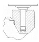
Soporte con placa y espiga roscada, con y sin freno. Freno ergonómico redondeado con retorno integrado. Fabricadas en poliamix reforzado. Diseñadas epecialmente para el sector mobiliario y restauración. Color personalizado opcional. Fabricadas según normas europeas EN 12528.
