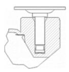
Soporte con placa y espiga roscada, con y sin freno. Freno ergonómico redondeado con retorno integrado. Fabricadas en poliamix negro reforzado. Diseñadas epecialmente para el sector mobiliario y restauración. Color personalizado opcional. Fabricadas según normas europeas EN 12528.
