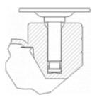
Soporte de plastico para albergar las dos ruedas gemelas. Fijaciones: platina,espiga roscada, espiga con anilla, espiga lisa, fijación para cantos. Cubierta: Negro, gris, latonado,cromado. Aro: Bandaje en polipropileno negro o gris, poliuretano gris.
